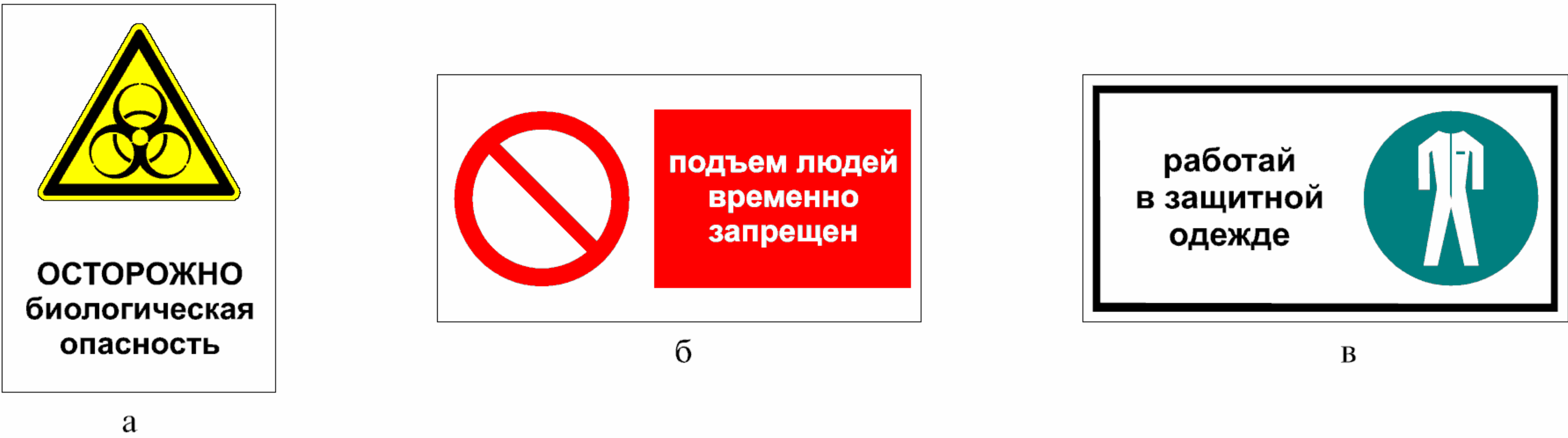
а — текст расположен ниже знака безопасности; б — текст расположен справа от знака безопасности; в — текст расположен слева от знака безопасности
