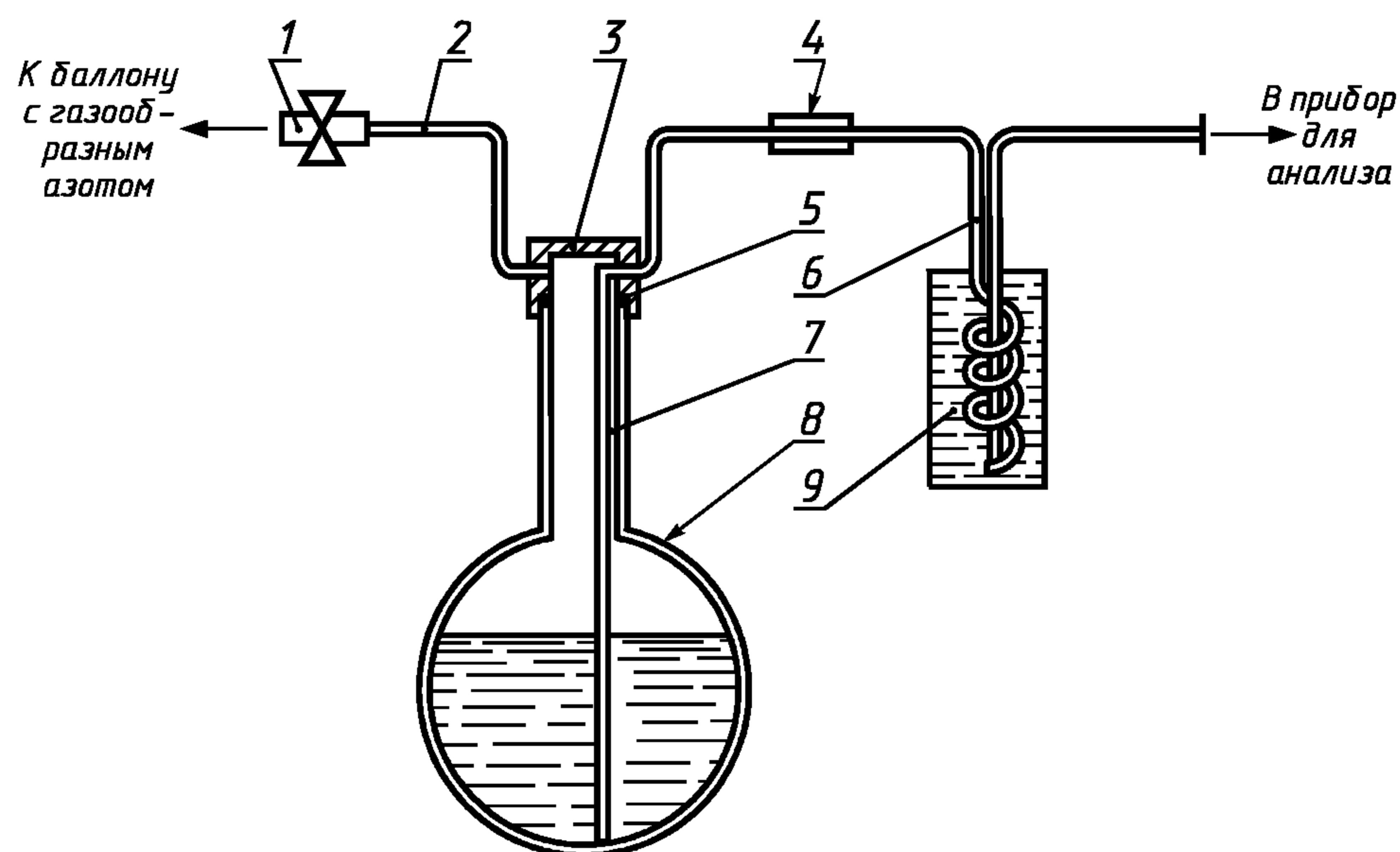
1 — резиновая трубка с зажимом; 2 — медная трубка  $6 \times 1$  мм; 3 — крышка; 4 — резиновая трубка; 5 — прокладка; 6 — испаритель; 7 — трубка из нержавеющей стали  $3 \times 0,7$  мм; 8 — криогенный сосуд; 9 — сосуд с водой
