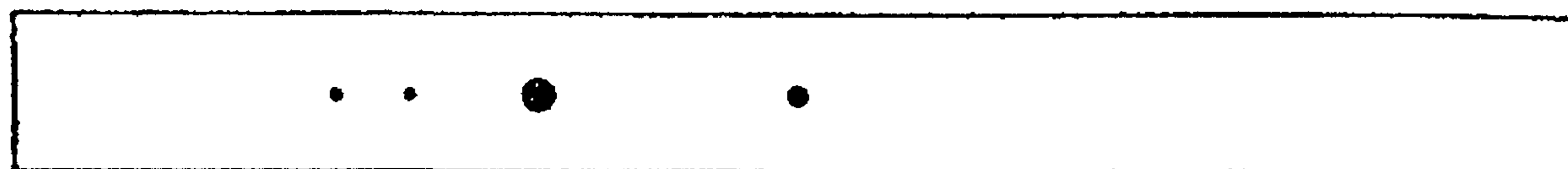
Пример 2: один дефект диаметром 3,2 мм; один - 1,6 мм; два - 0,8 мм.
