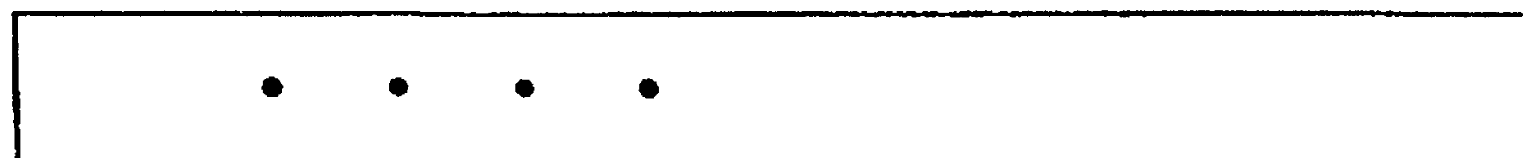
Пример 4: четыре дефекта диаметром 1,6 мм.
