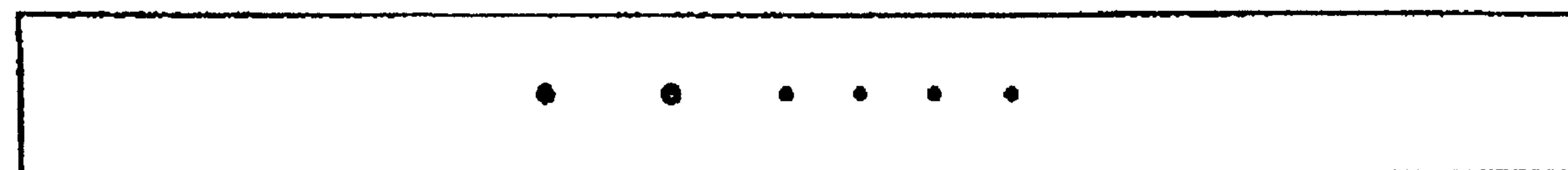
Пример 5: два дефекта диаметром 1,6 мм; четыре - 0,8 мм.
