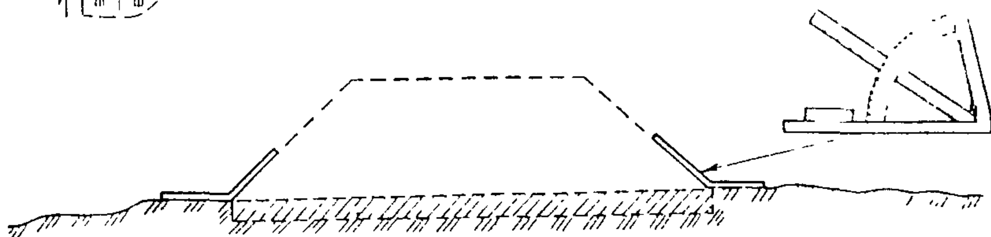
Рис. 4.12. Схема установки откосников по границе земляного полотна
