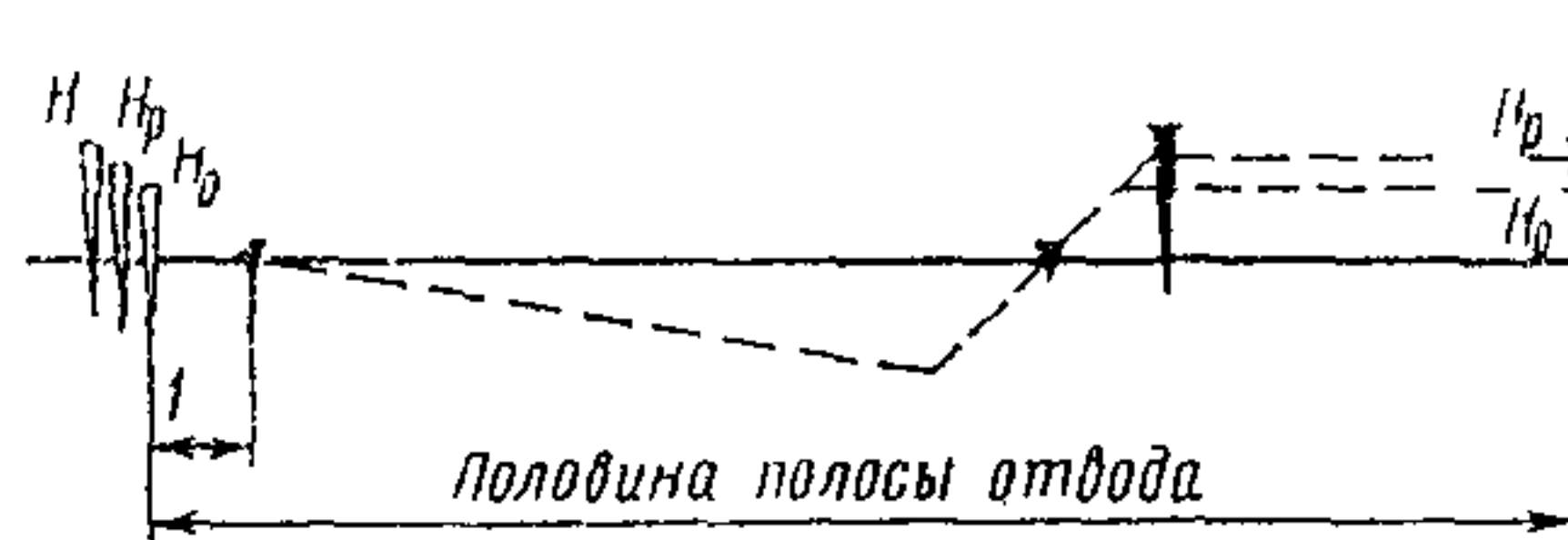
Рис 34 Схема установки кольев из обрезков с нанесением на них высотных отметок
