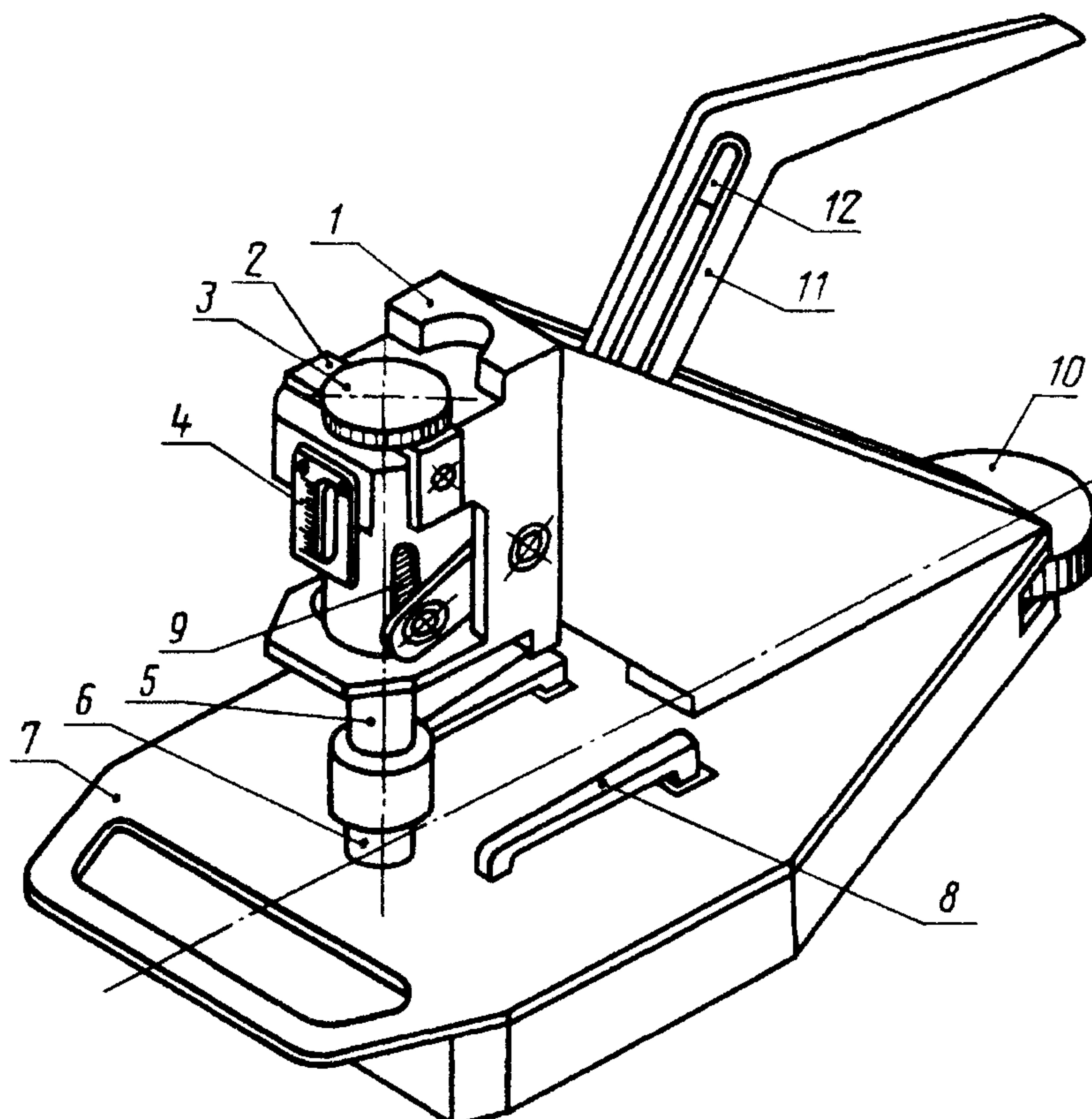
1 — корпус; 2 — скоба; 3 — регулировочный винт нагрузки; 4 — шкала; 5 — шток; 6 — резиновый пуансон; 7 — рабочий столик; 8 — зажимы образца; 9 — пружина; 10 — колесо регулировки зажимов; 11 — рукоятка; 12 — фиксатор рукоятки
