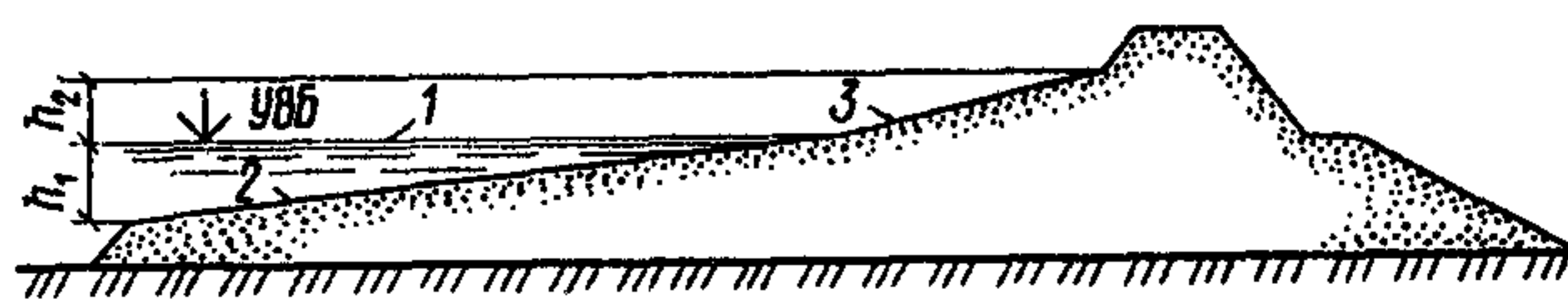
Определение крутизны верхового неукрепленного откоса песчаной плотины
