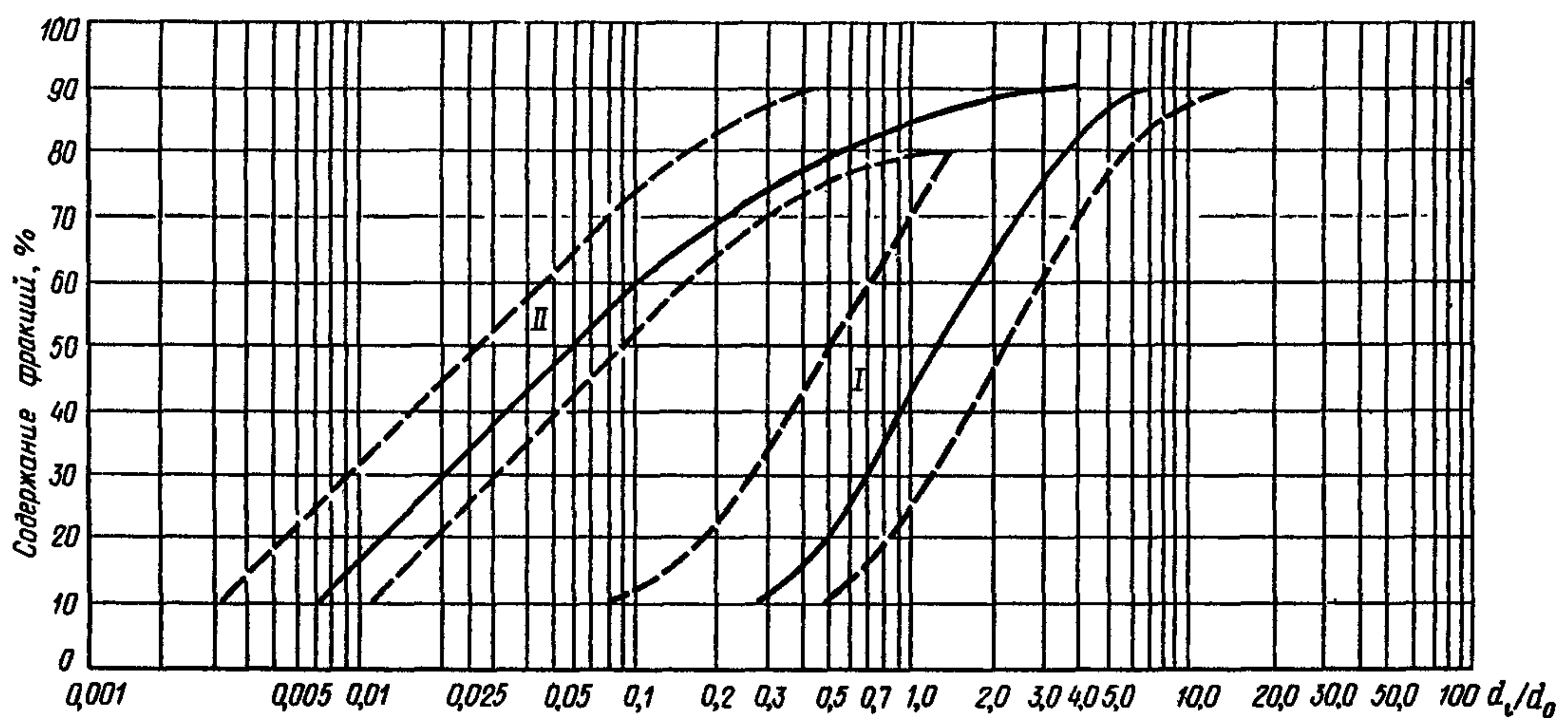
Черт. 4. График зависимости \alpha = f\left(\frac{d_i}{d_o}\right) : Гравийные плотины с ядром высотой менее 30 м
