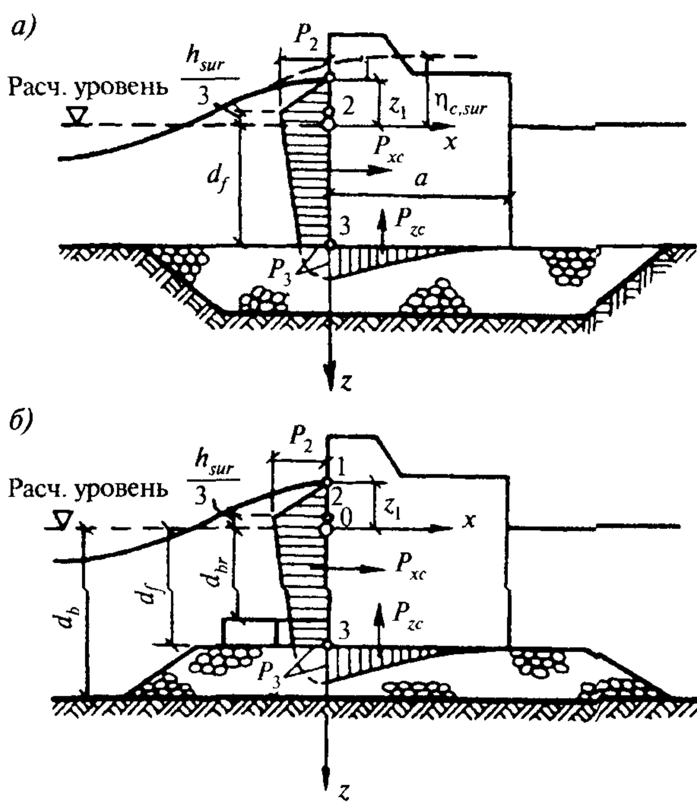
**Рис. 9.** Эпюры давления прибойных волн на вертикальную стену
