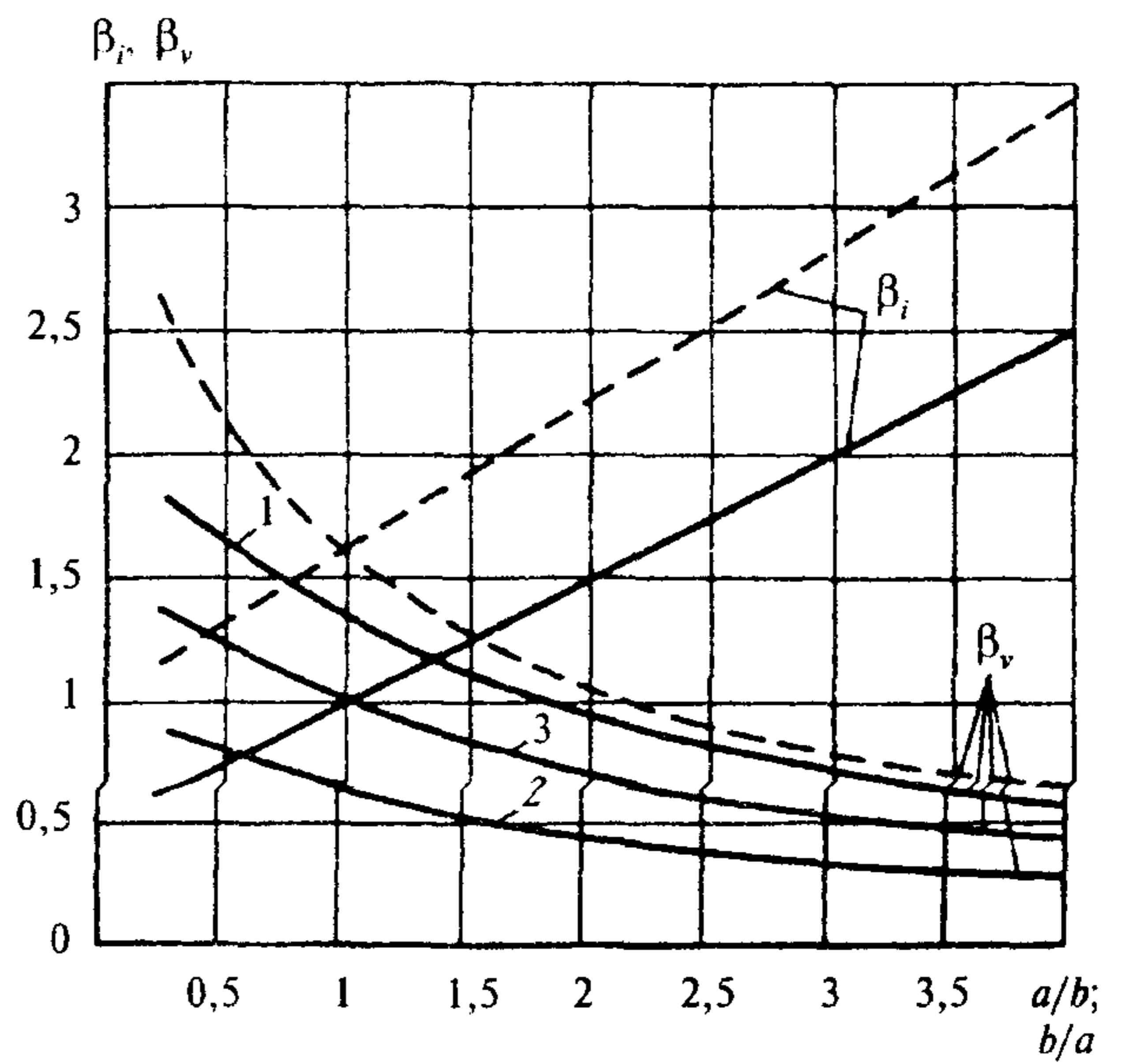
Рис. 17. Графики значений инерционного  $\beta_i$  и скоростного  $\beta_v$  коэффициентов формы (для эллиптических преград — сплошные линии, призматических — штриховые линии) в зависимости от  $a/b$  (для  $Q, q$  и  $P_x$ ) или  $b/a$  (для  $P_z$ )
