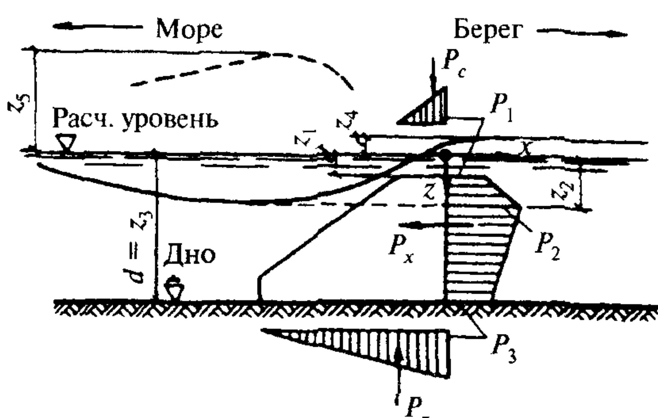
Рис. 26. Эпюры волнового давления на подводный волнолом
