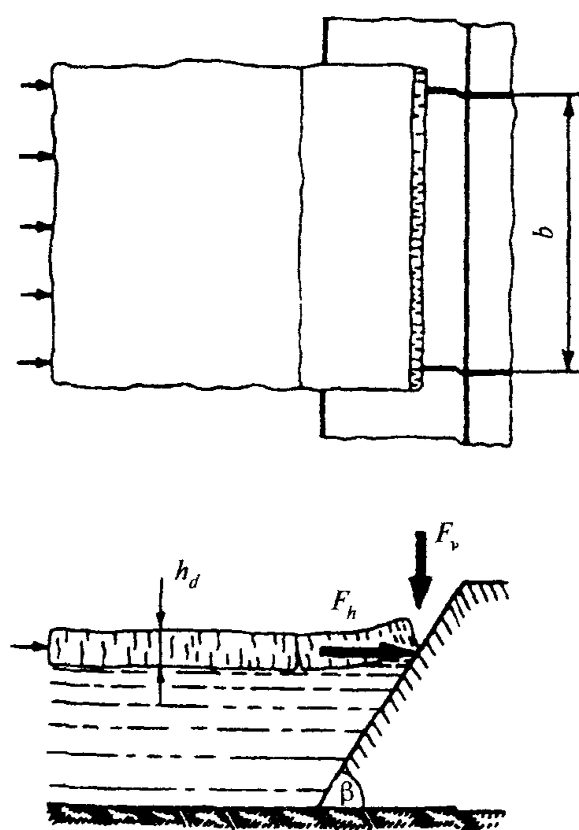
Рис. 38. Схема приложения нагрузок от движущегося ледяного поля на сооружение откосного профиля
