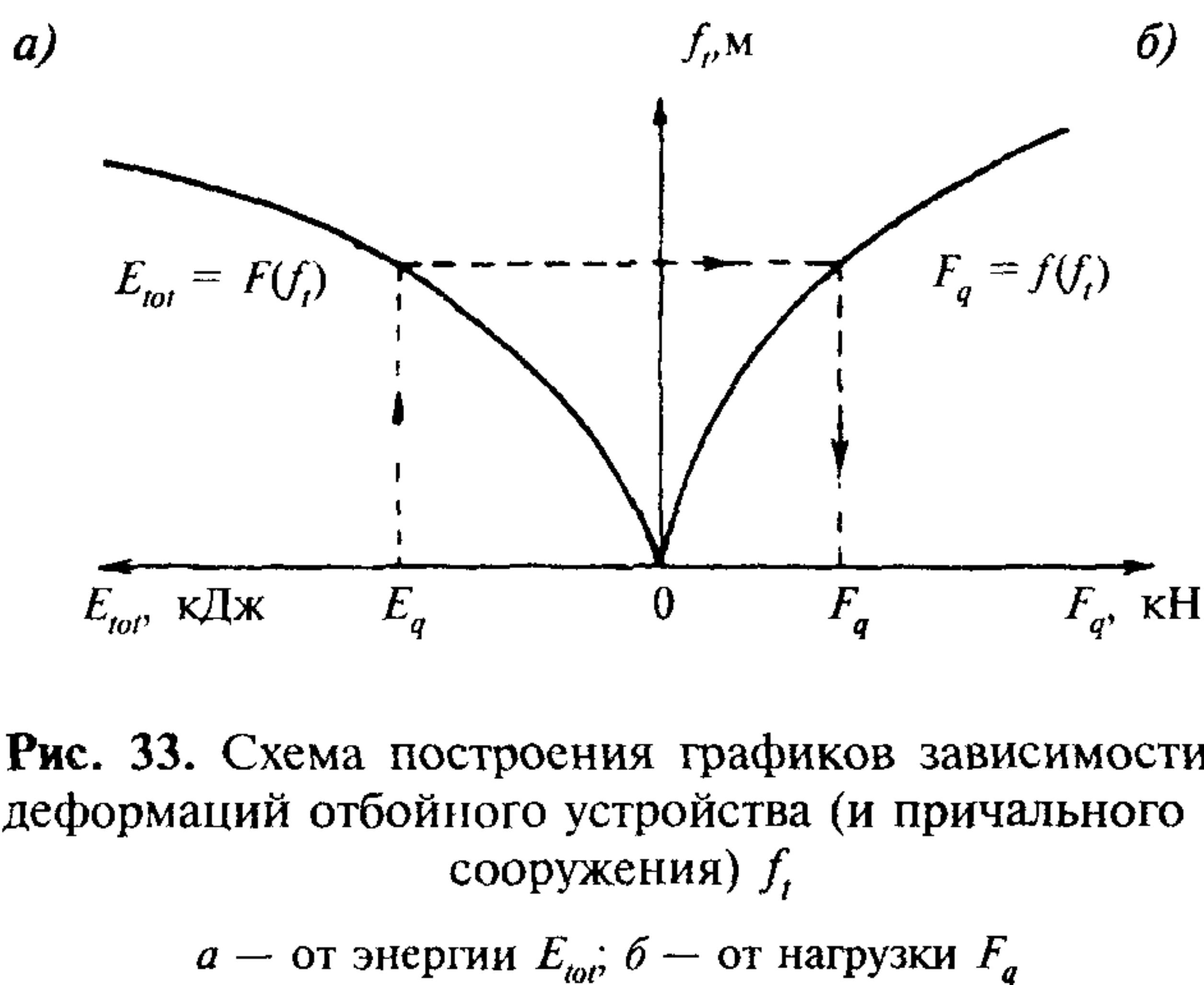
Рис. 33. Схема построения графиков зависимости деформаций отбойного устройства (и причального сооружения)  $f_t$
