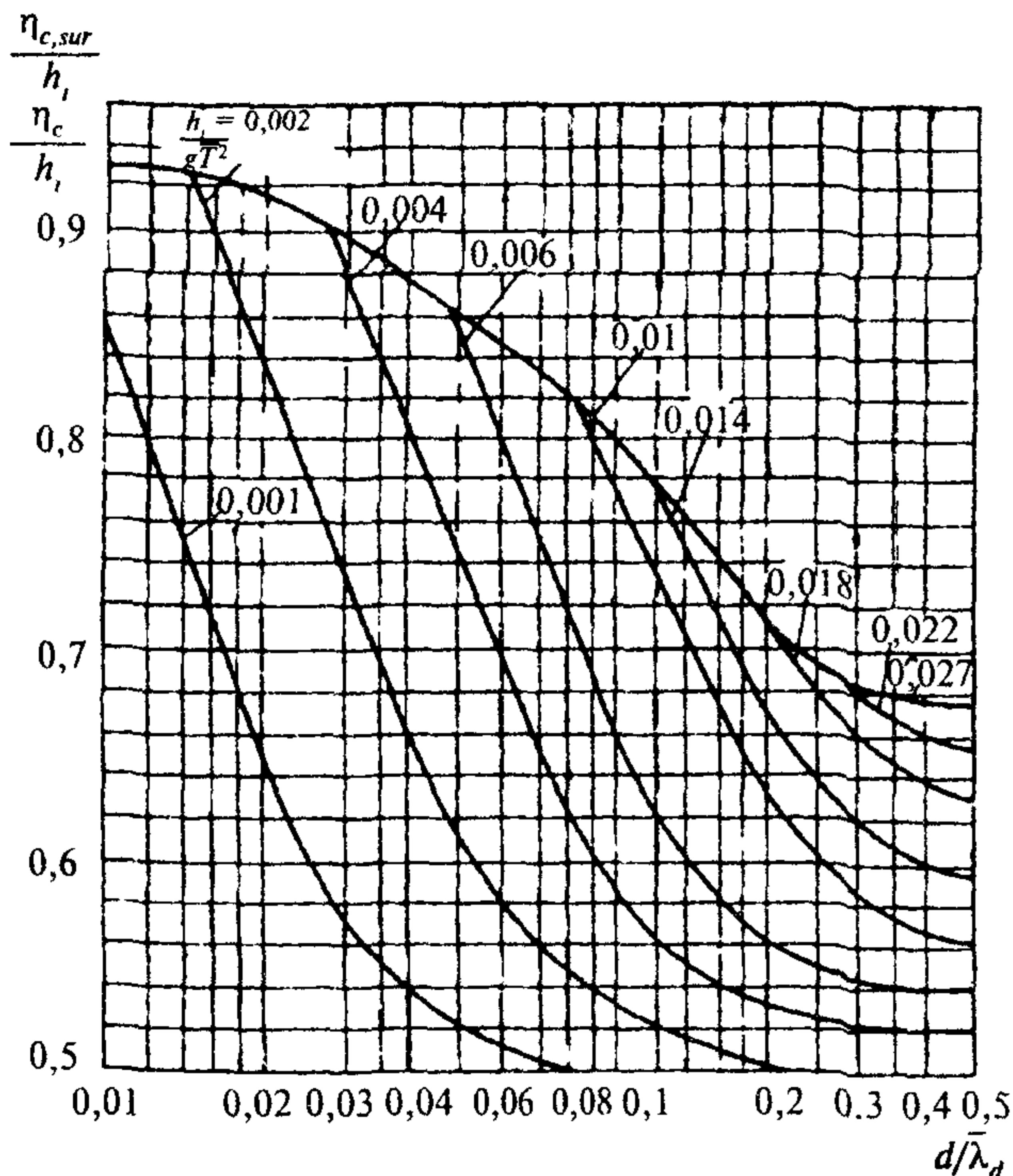
Рис. 3. Графики для определения значений  $\eta_c/h$ , в мелководной и  $\eta_{c,sur}/h$ , в прибойной зонах
