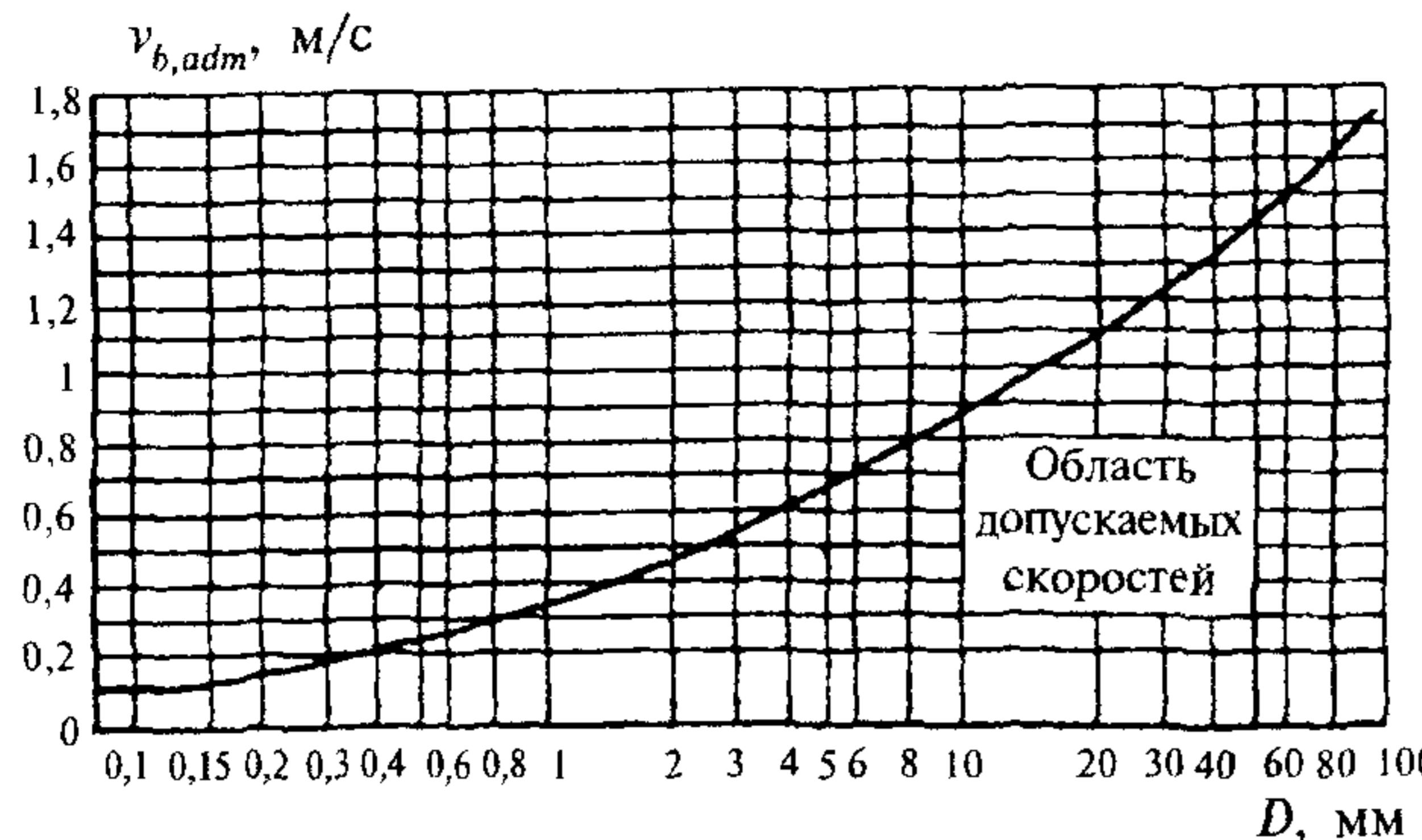
Рис. 7. График допускаемых значений неразмывающих донных скоростей
