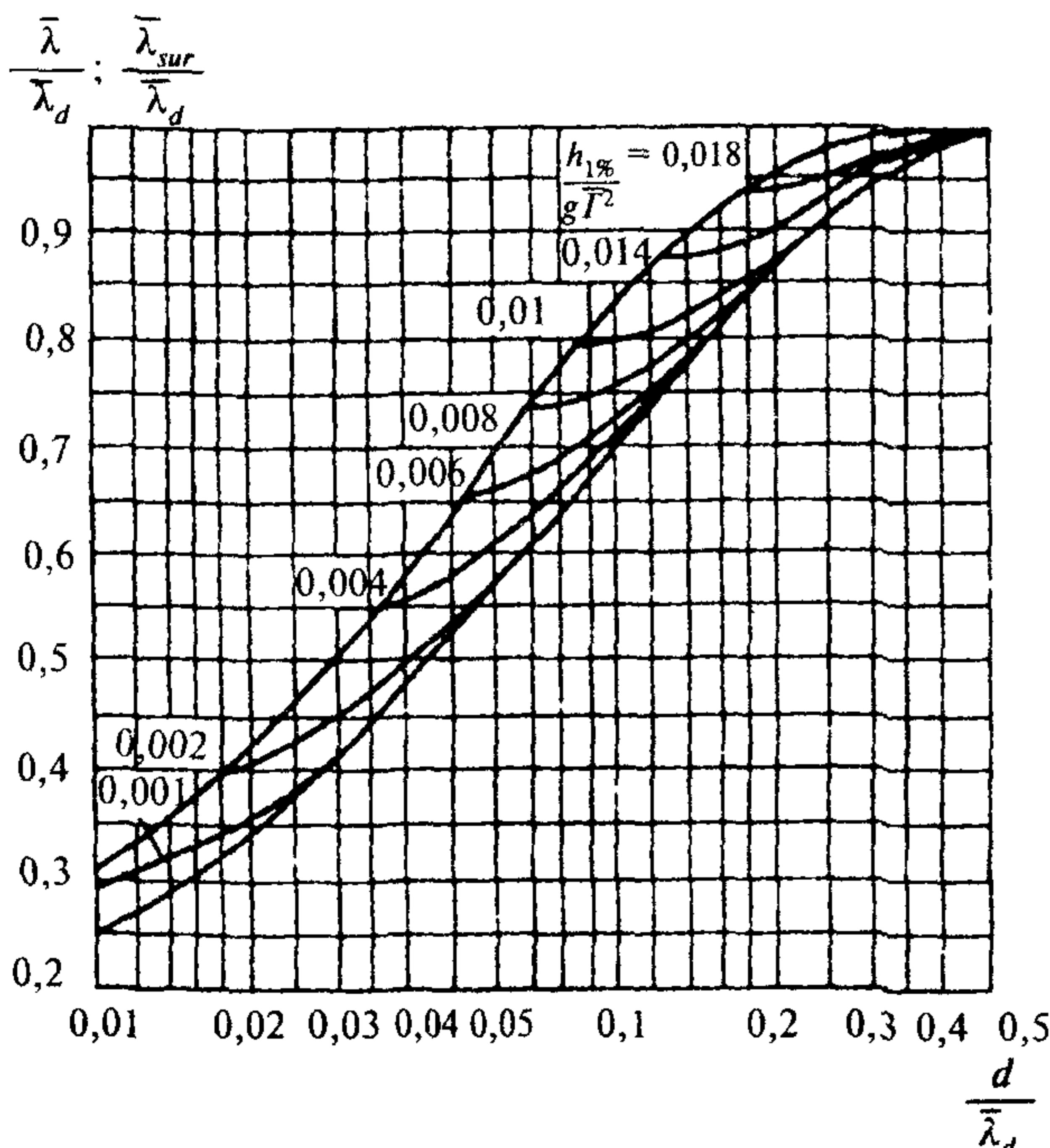
Рис. 4. Графики для определения значений  $\bar{\lambda}/\bar{\lambda}_d$  и  $\bar{\lambda}_{sur}/\bar{\lambda}_d$  в мелководной и прибойной зонах
