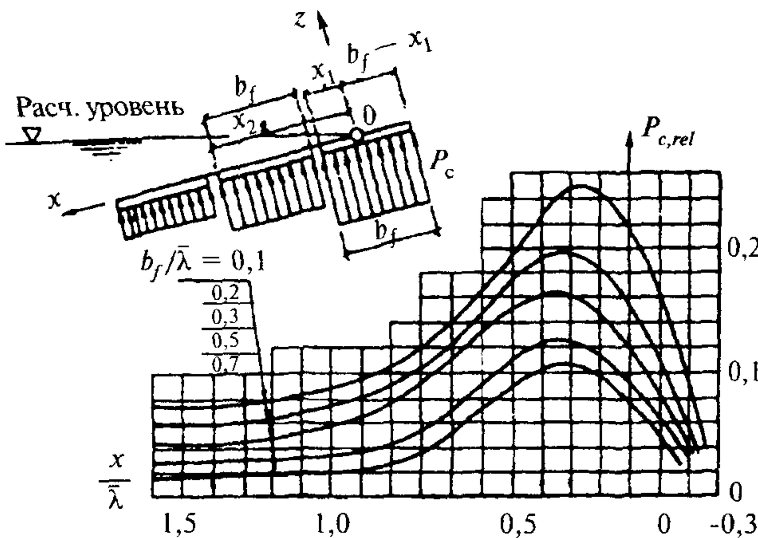
Рис. 12. Графики для определения относительного волнового противодавления
