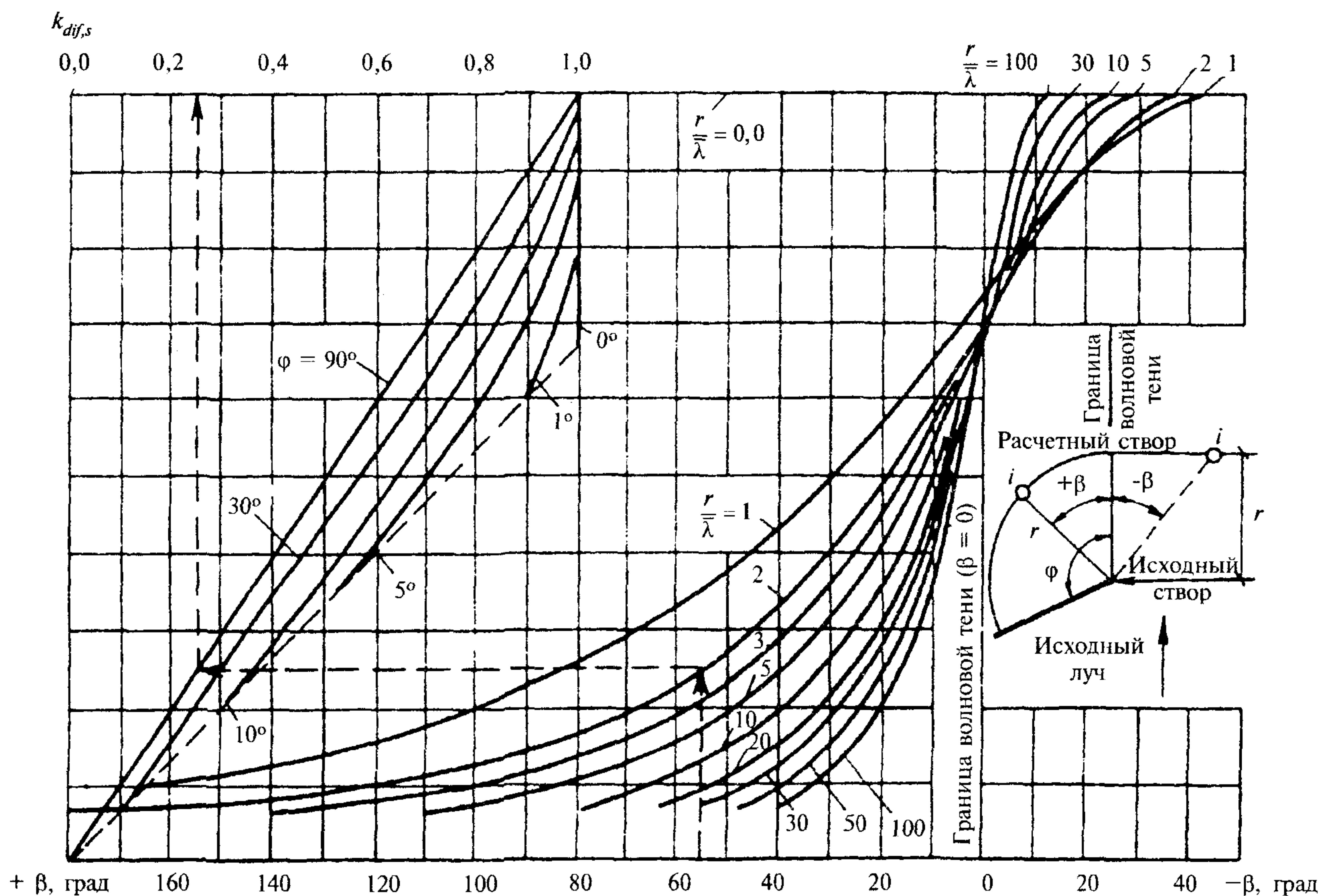
Рис. 7. Графики для определения значений коэффициента  $k_{dif,s}$
