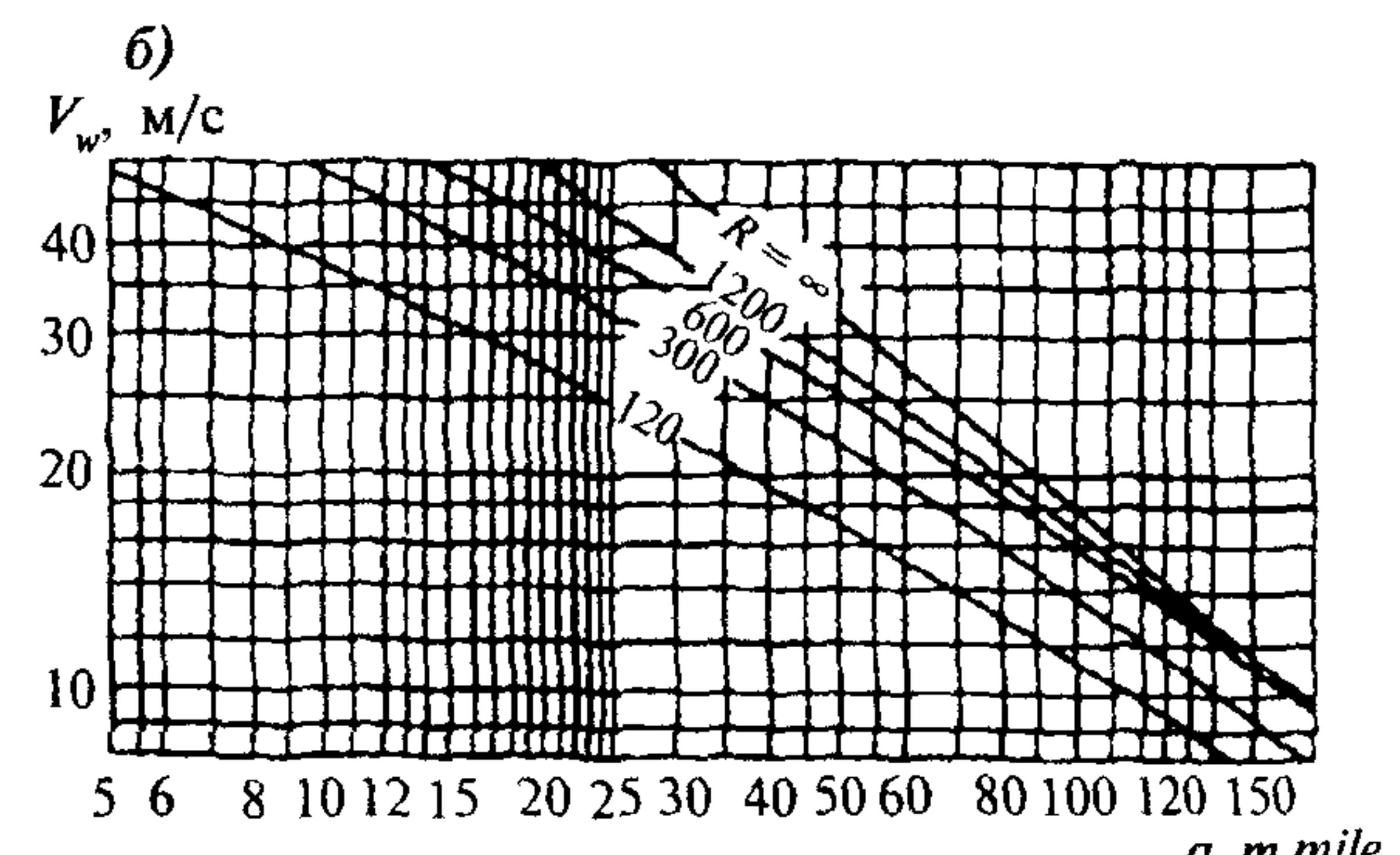
Графики для определения расчетной скорости ветра  $V_w$ , м/с, по данным синоптических изобарах, проведенных через 0,5 кПа
