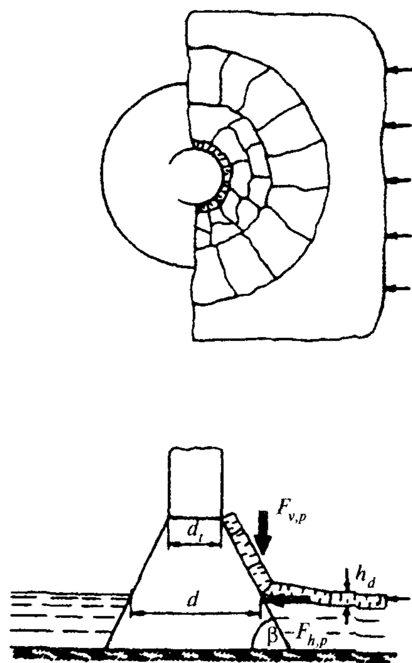
Рис. 37. Схема приложения нагрузок от движущегося ледяного поля на отдельно стоящую коническую опору
