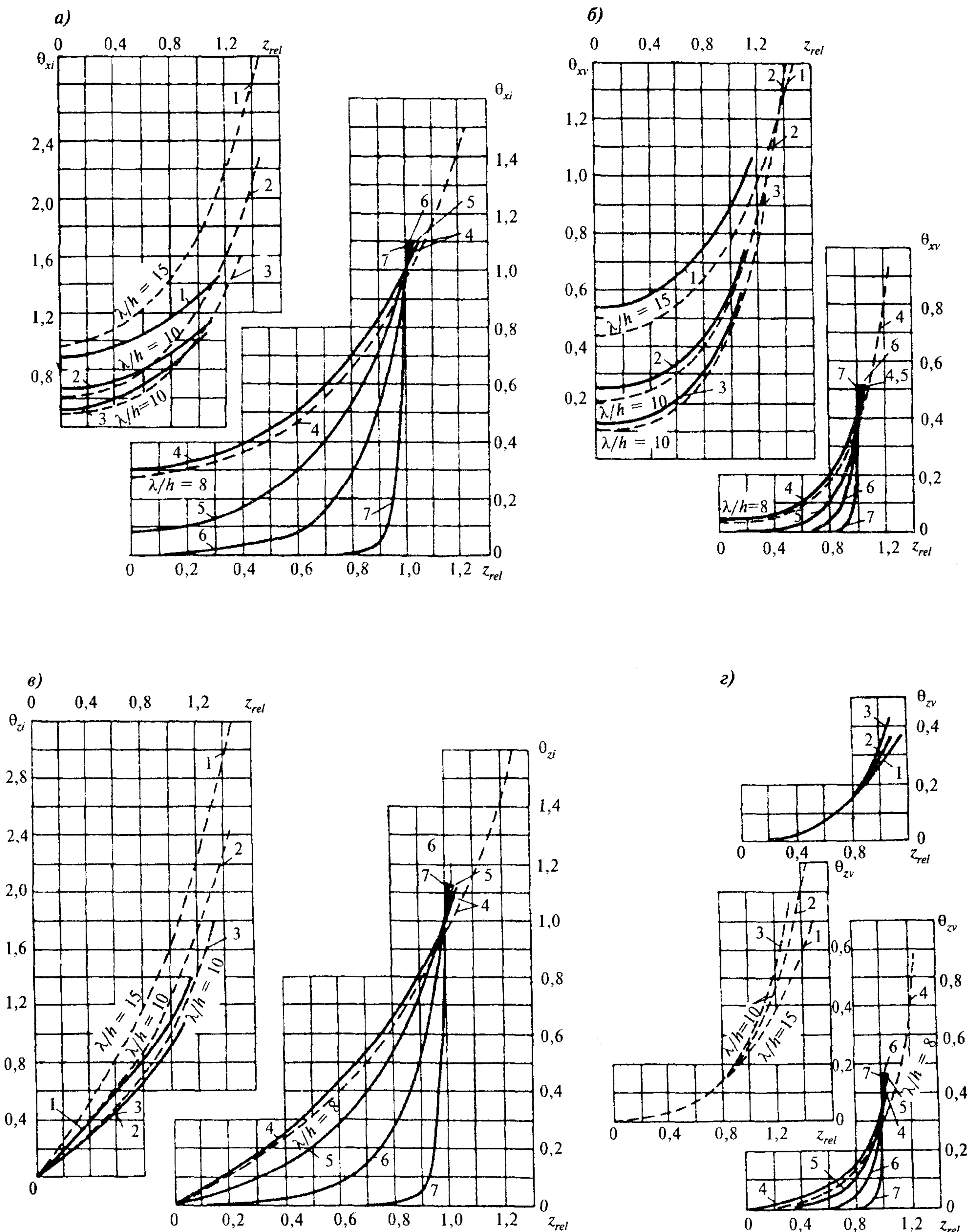
Рис. 19. Графики коэффициентов линейной нагрузки от волн  $\theta_{xi}$ ,  $\theta_{xv}$ ,  $\theta_{zi}$ ,  $\theta_{zv}$ , при  $d/\lambda$ :
