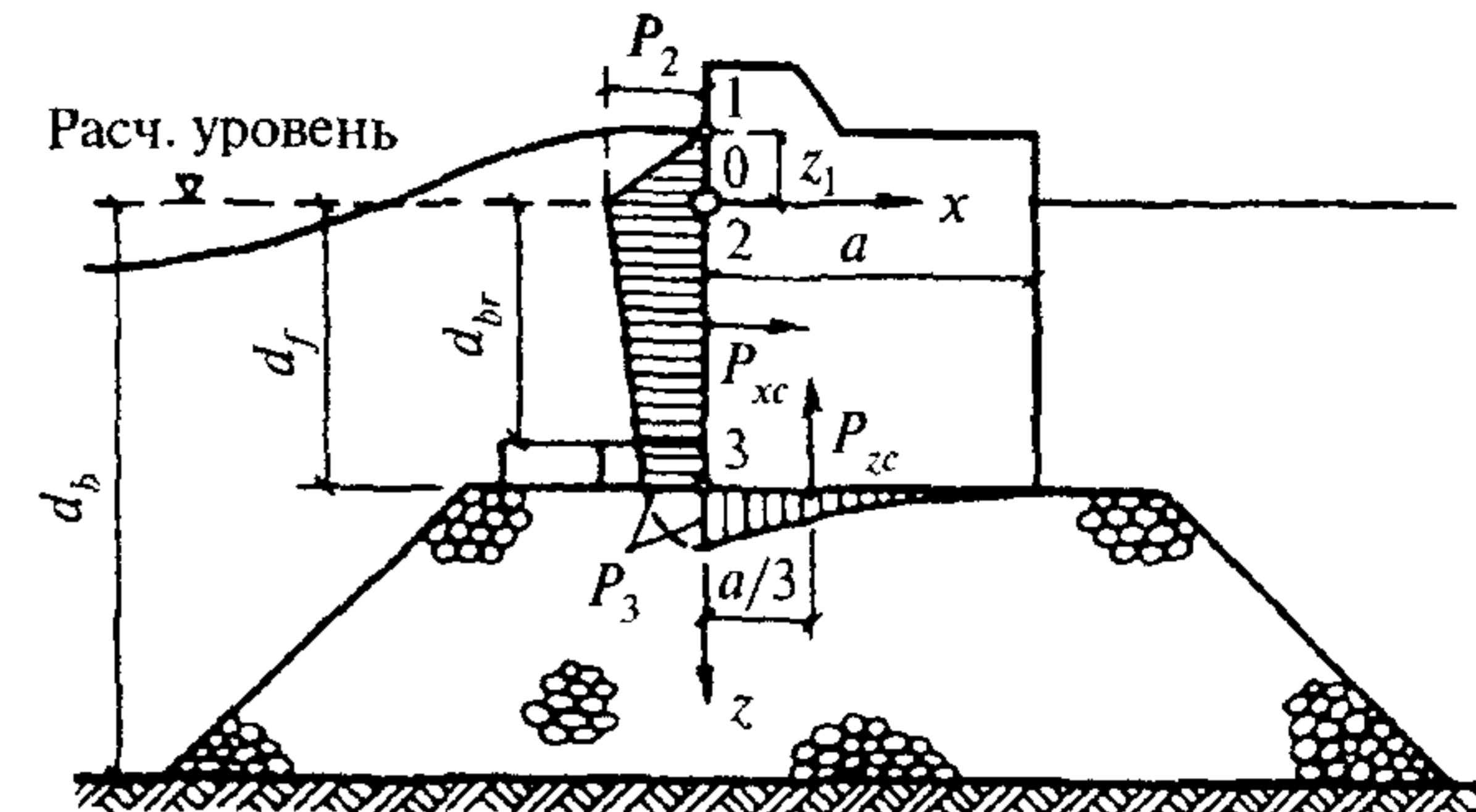
Рис. 8. Эпюры давления разбивающихся волн на вертикальную стену
