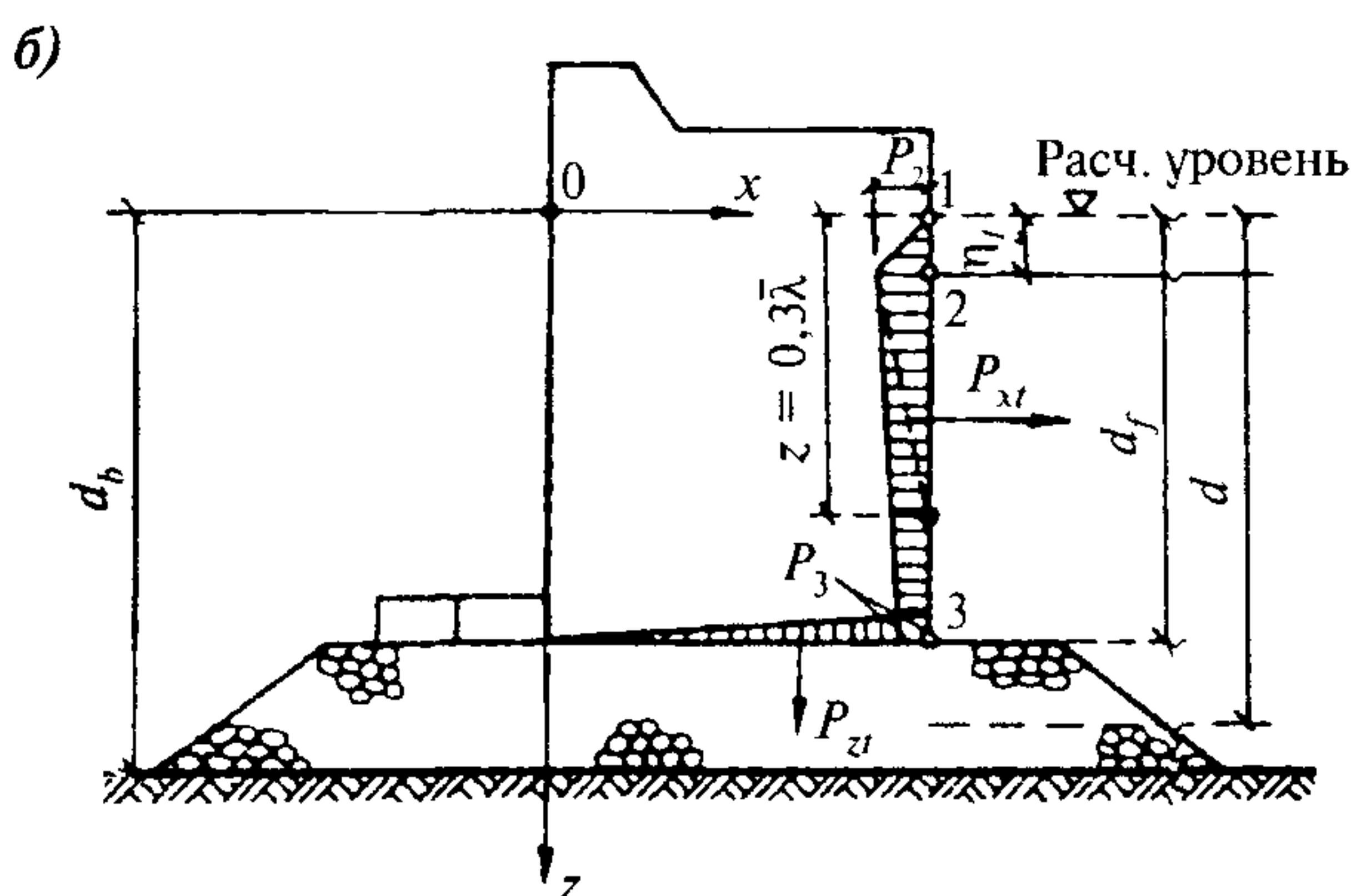
Рис. 6. Эпюры давления дифрагированных волн на вертикальную стену со стороны огражденной акватории
