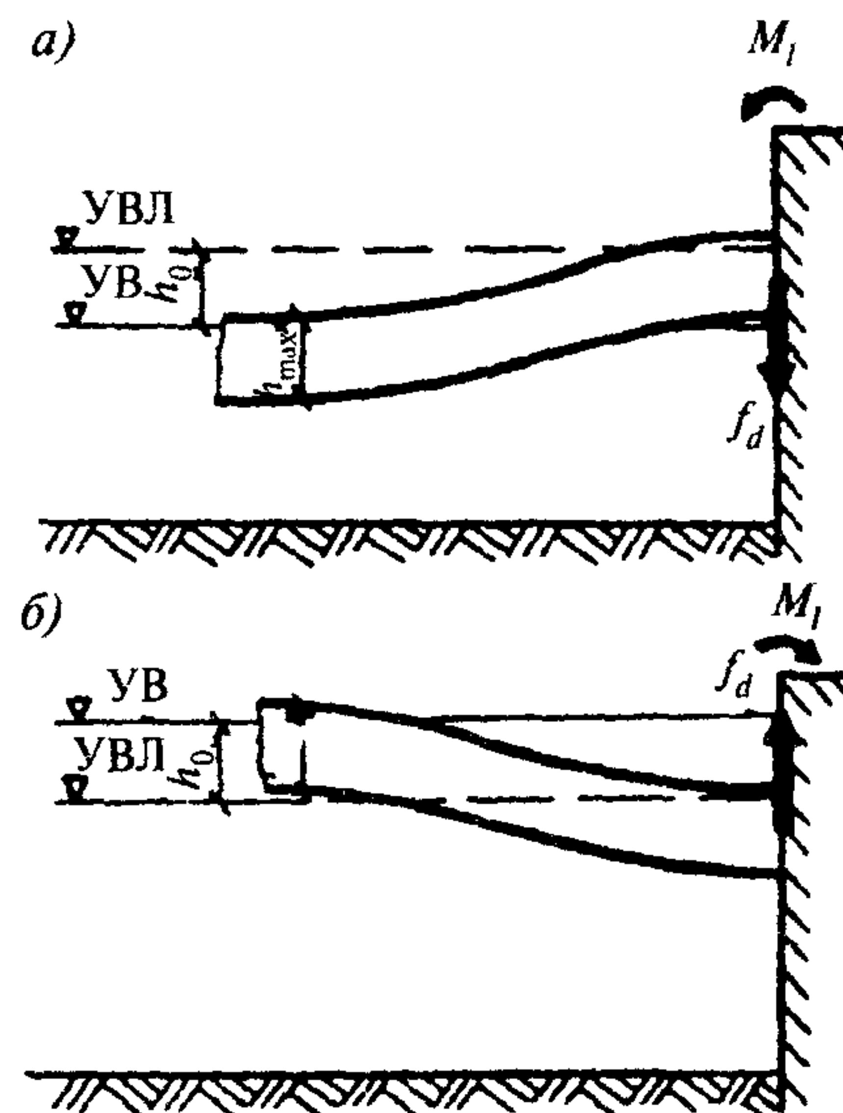
**Рис. 41.** Схемы приложения нагрузок от примерзшего к сооружению ледяного покрова при изменении уровня воды (УВ)
