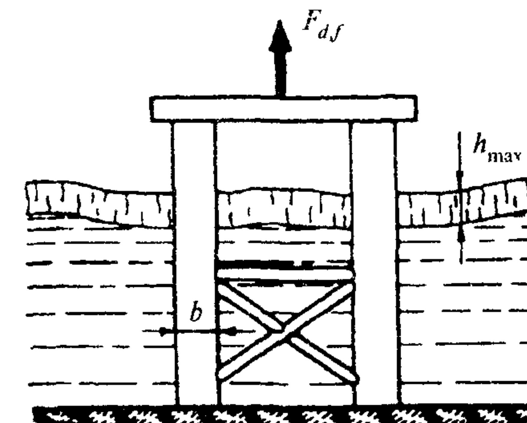
**Рис. 43.** Схема приложения нагрузки от примерзшего к сооружению из системы вертикальных колонн ледяного покрова при повышении уровня воды (при понижении уровня воды сила  $F_{d,f}$  направлена вниз)
