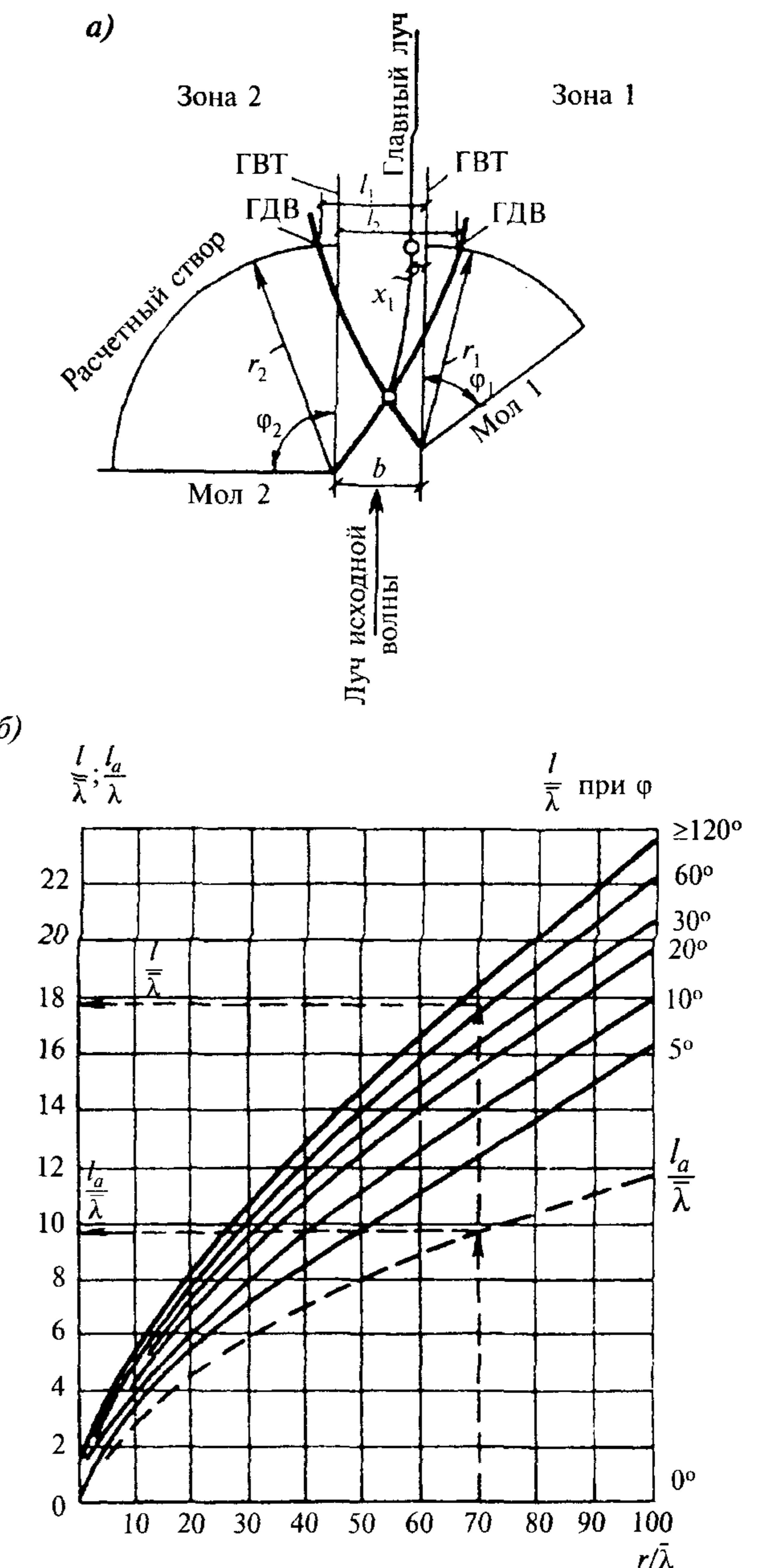
Рис. 9. Схема (а) и графики (б) для определения величин  $l$  и  $l_a$
