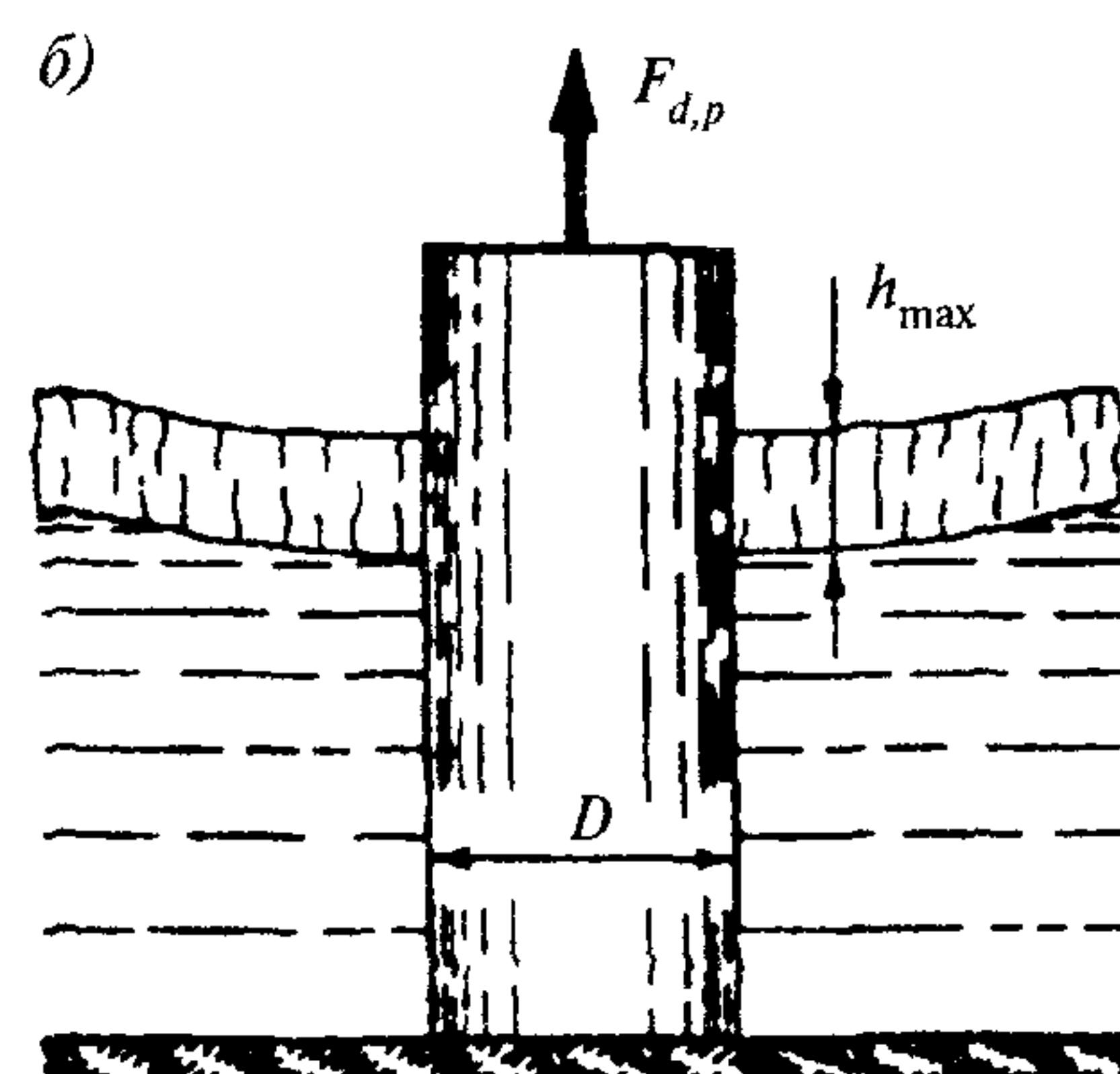
**Рис. 42.** Схемы приложения нагрузки от примерзшего к отдельно стоящей опоре ледяного покрова при изменении уровня воды (УВ)
